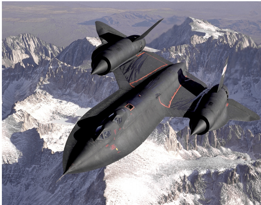
Rysunek 3.11: Samolot zwiadowczy SR-71 Blackbird, wyposażony w silniki odrzutowo-strumieniowe
