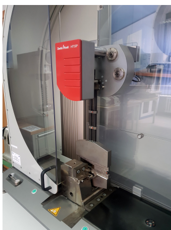
Rysunek 5.8: Stanowisko do badania udarności materiałów
