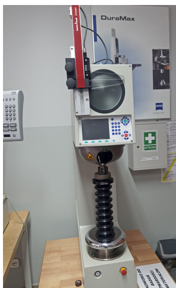
Rysunek 5.7: Stanowisko do badania twardości materiałów
