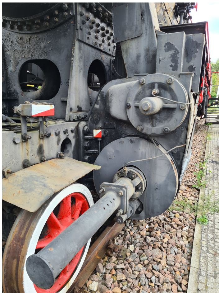
Rysunek 3.2: Cylinder silnika parowego wraz z układem rozrządu
