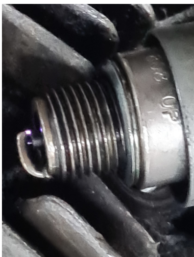
Rysunek 3.8: Świeca zapłonowa, w momencie przeskoku iskry pomiędzy elektrodami
