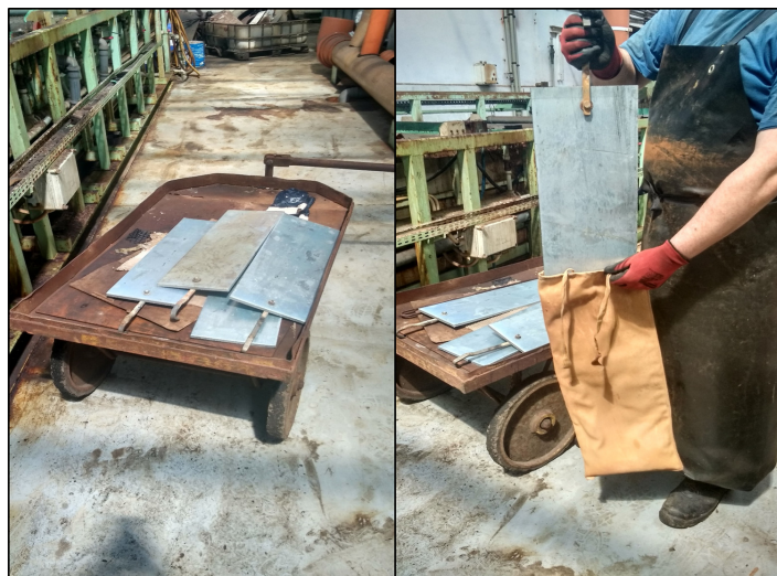
Rysunek 5.5: Anody wykorzystywane w procesie cynkowania
