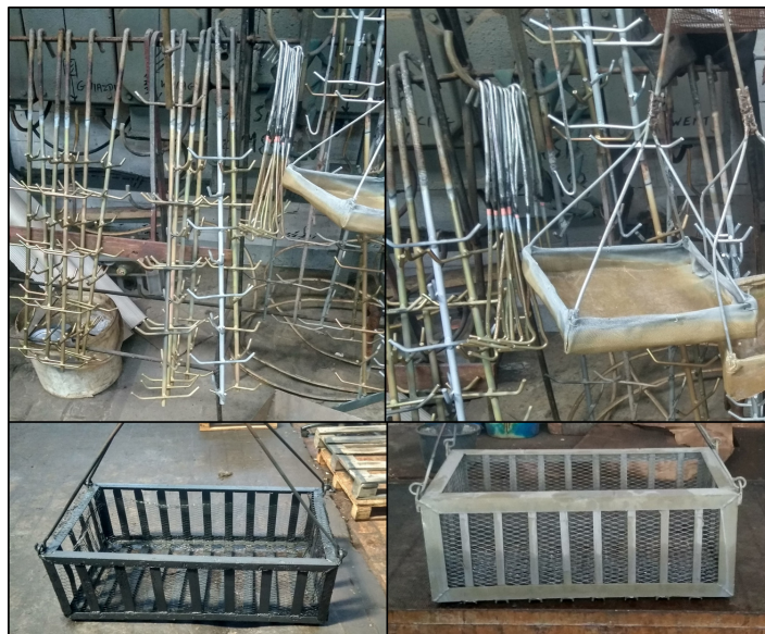
Rysunek 5.8: Kosze i uchwyty stosowane w procesach galwanicznych do umieszczania przedmiotów w kąpielach
