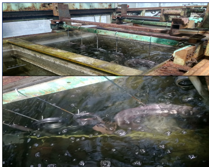
Rysunek 5.7: Zawieszona na uchwytnych przedmioty w kąpielach galwanicznych
