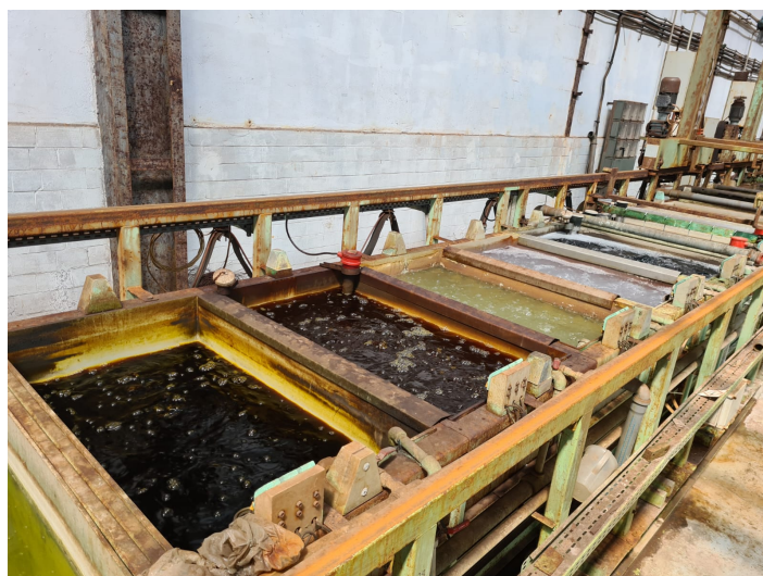
Rysunek 5.4: Wanny wykorzystywane w procesach galwanicznych
