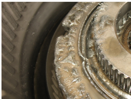
Rysunek 7.3: Awaryjne zużycie przekładni zębatej
