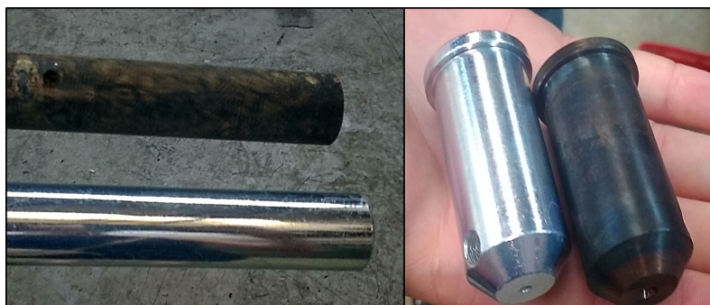
Rysunek 5.6: Porównanie przedmiotów przed i po cynkowaniu
