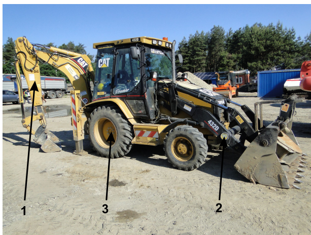
Rysunek 7.1: Miejsce usytuowania układu napędowego oraz układu roboczego w koparkoładownicy: 1 – układ roboczy (osprzęt koparkowy), 2 – układ roboczy (osprzęt ładowarkowy), 3 – układ napędowy
