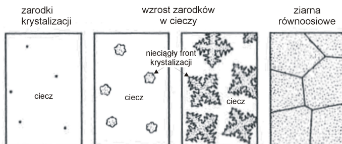
Rysunek 6.13: Schematyczne przedstawianie krystalizacji objętościowej stopu
