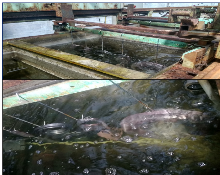
Rysunek 5.7: Zawieszona na uchwytych przedmioty w kąpielach galwanicznych
