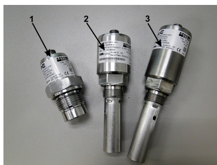
Rysunek 7.6: Czujniki do pomiarów wybranych parametrów oleju umożliwiające pracę zdalną: 1 – czujnik do wykrywania cząstek ferromagnetycznych, 2 – czujnik do pomiarów zawartości wody, 3 – czujnik do pomiarów lepkości oleju
