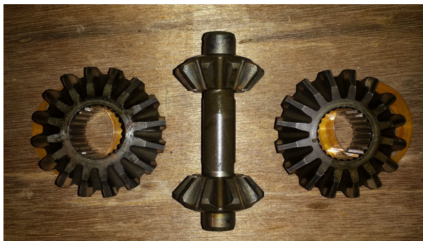
Rysunek 2.2: Podstawowe elementy klasycznego mechanizmu różnicowego: koła koronkowe oraz satelity wraz z ich osią
