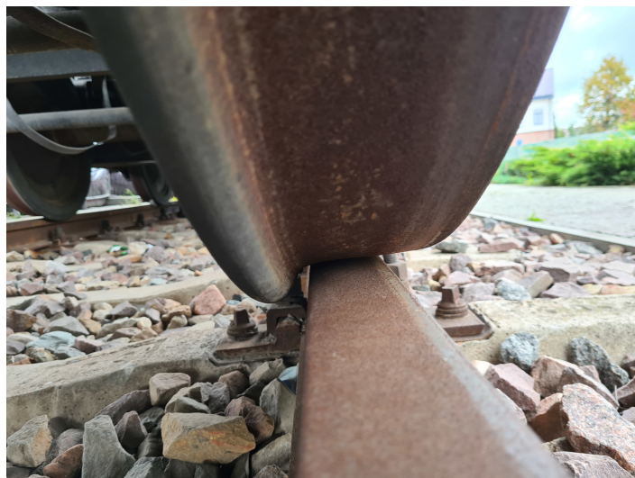
Rysunek 2.10: Koło lokomotywy z widocznie zmieniającą się średnicą
