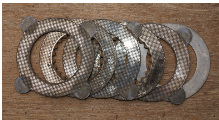
Rysunek 2.5: Tarcze cierne stosowane w mechanizmach różnicowych o zwiększonych tarciu wewnętrznym, zwanych popularnie „szperą”
