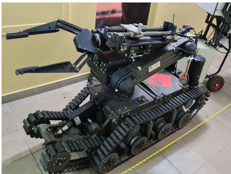
Rysunek 2.7: Zdalnie sterowany pojazd na podwoziu gaśnicowym wykorzystywany przez saperów
