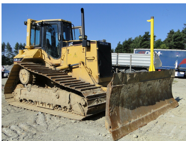
Rysunek 3.2: Spycharka – podwozie gąsienicowe
