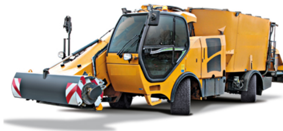
Rysunek 4.17: Przykładowy pojazd specjalistyczny z zastosowanymi napędem hydraulicznym w układzie roboczym
