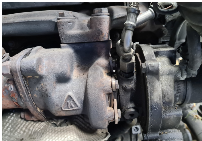
Rysunek 6.3: Turbosprężarka w silniku z zapłonem iskrowym
