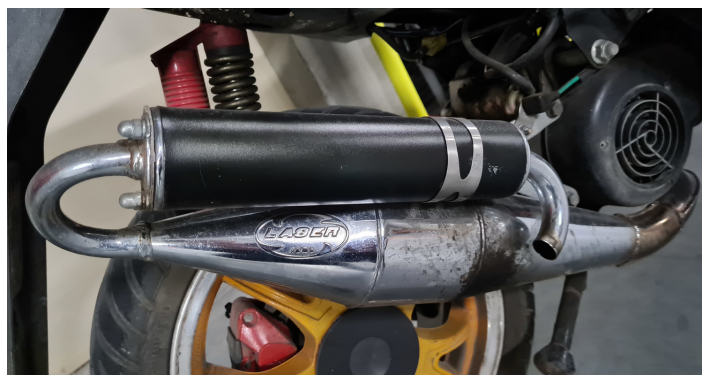
Rysunek 6.11: Układ wydechowy silnika dwusuwowego klasy 50 cm 3
