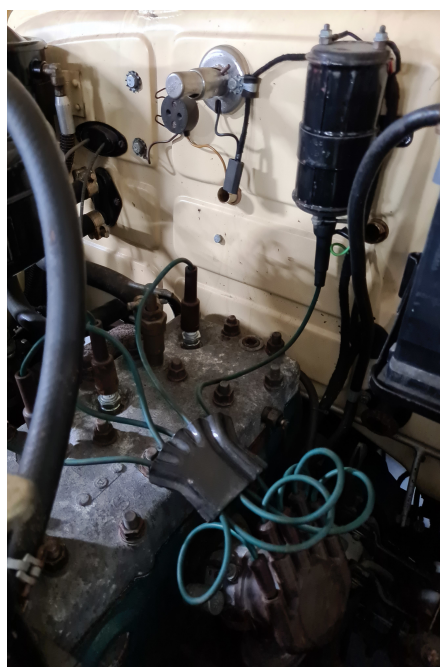
Rysunek 6.8: Układ zapłonowy z mechanicznym przerywaczem, pojedynczą cewką i rozdzielaczem (FSO Warszawa M20)
