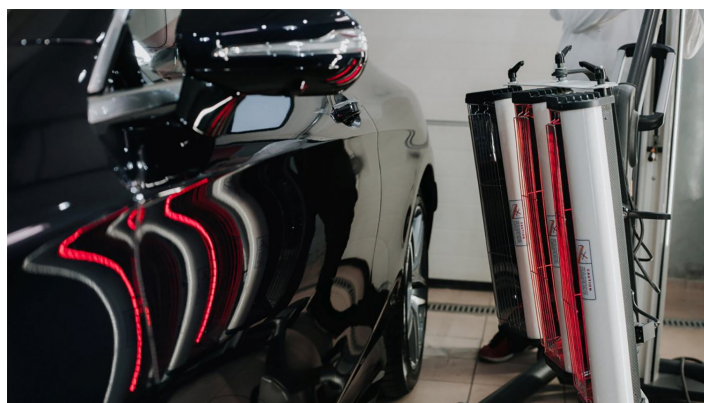
Rysunek 9.1: Utwardzanie powłoki lakierniczej na gotowym wyrobie
