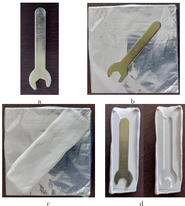
Rysunek 10.16: Wykonanie formy odlewniczej: a) model, b) model na podłożu z folii, c) masa formierska na modelu, d) gotowa forma z otworem wlewowym
