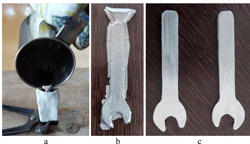
Rysunek 10.18: Wykonanie odlewu: a) zalewanie formy, b) odlew po wyjęciu z formy, c) gotowy odlew po oczyszczeniu
