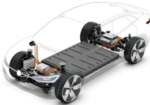
Rysunek 4.16: Przekładnie elektryczne zastosowane w osiach napędowych samochodu
