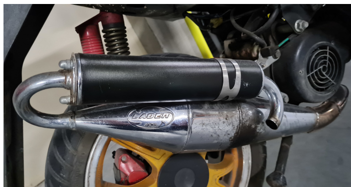
Rysunek 6.11: Układ wydechowy silnika dwusuwowego klasy 50 cm 3
