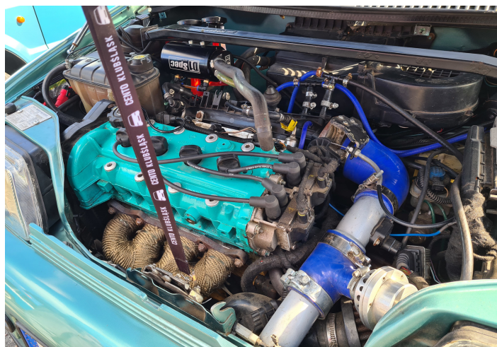
Rysunek 6.4: Silnik z turbodoładowaniem w zmodyfikowanym Fiacie Cinquecento
