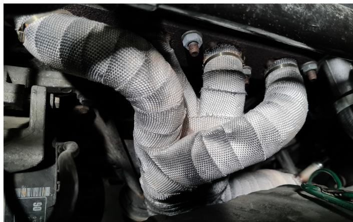
Rysunek 6.10: Kolektor wydechowy silnika 4-cylindrowego wyposażony w izolację cieplną
