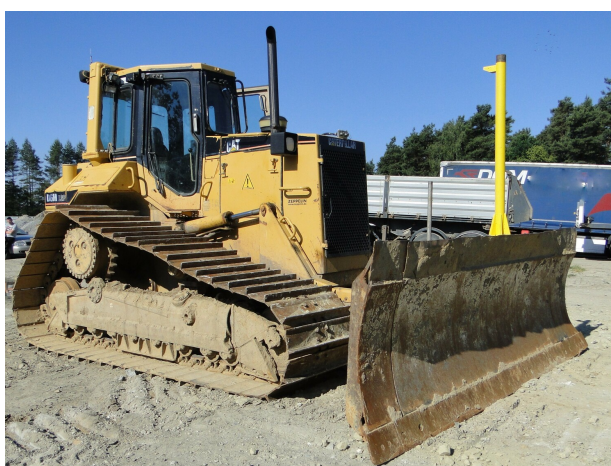
Rysunek 3.2: Spycharka – podwozie gąsienicowe
