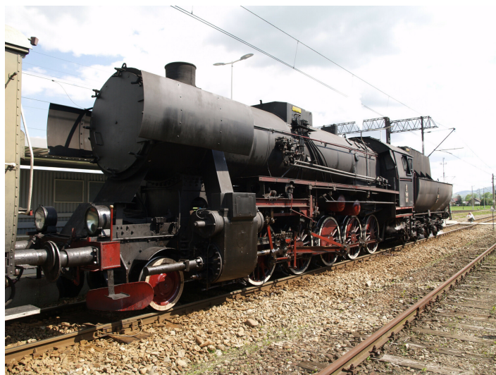
Rysunek 2.11: Lokomotywa parowa posiadająca w sumie 6 osi, zdolna do pokonywania nawet ciasnych łuków
