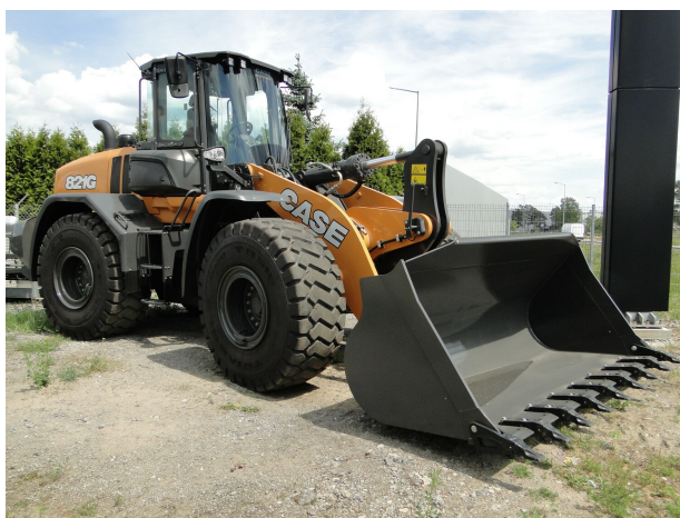
Rysunek 3.1: Ładowarka jednonaczyniowa – podwozie kołowe
