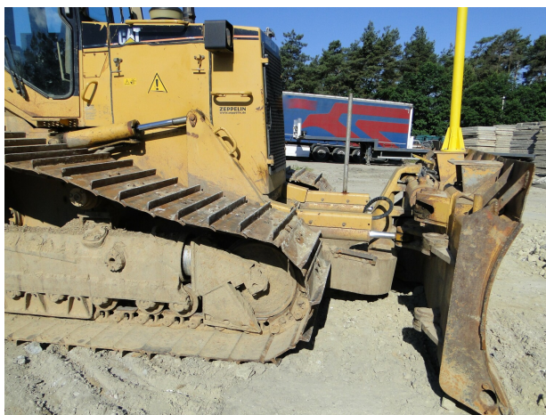
Rysunek 3.8: Układ roboczy spycharki
