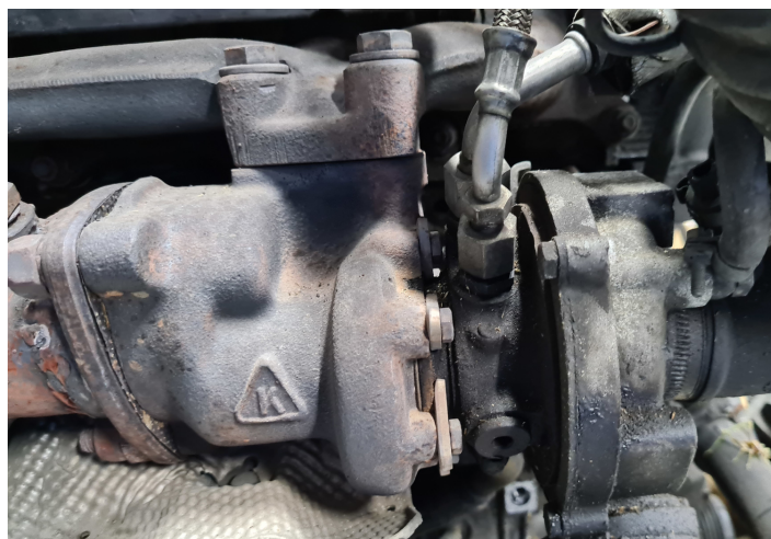
Rysunek 6.3: Turbosprężarka w silniku z zapłonem iskrowym
