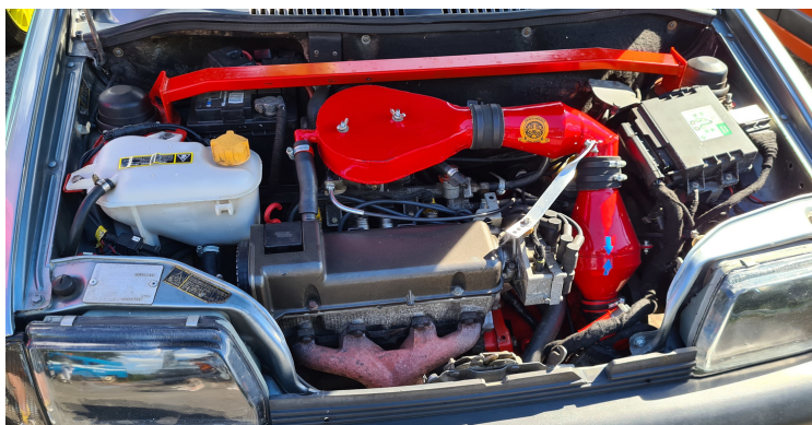
Rysunek 6.9: Sportowy układ dolotowy zastosowany w zmodyfikowanym Fiacie Cinquecento
