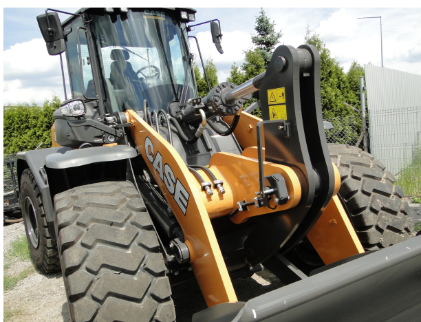
Rysunek 3.7: Układ roboczy ładowarki jednonaczyniowej
