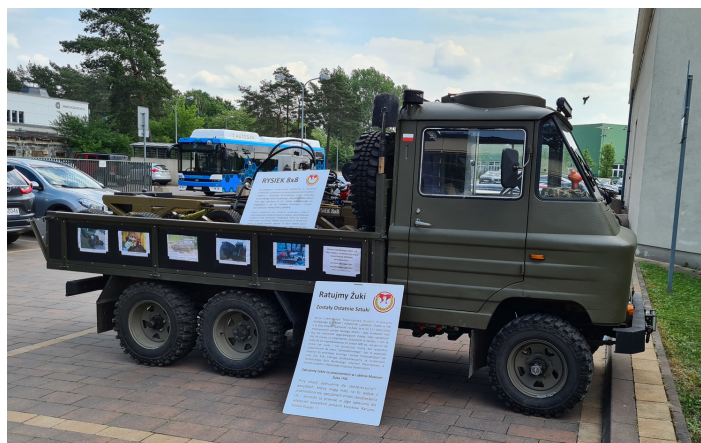
Rysunek 2.3: Zmodyfikowany samochód dostawczy Żuk wyposażony w napęd 6x6 i zbudowany na Politechnice Lubelskiej
