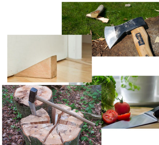
Rysunek 7.13: Przykłady klinów: ostrze siekiery lub noża, klin do łupania drewna, klin blokujący drzwi
