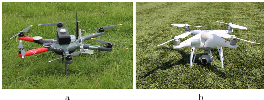
Rysunek 8.3: Dron w formie hexacoptera (a) i quadcoptera (b)
