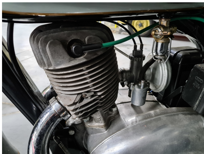
Rysunek 6.5: Motocyklowy silnik dwusuwowy o jednym cylindrze chłodzonym powietrzem (DKW NZ 350)
