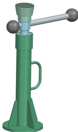
Rysunek 4.15: Przykład przekładni śrubowej
