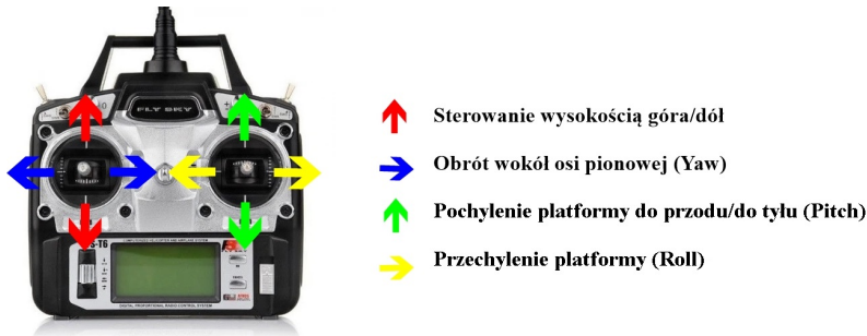
Rysunek 8.9: Podstawowe funkcje drążków sterowych
