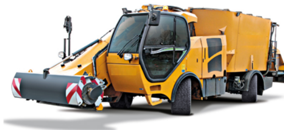
Rysunek 4.17: Przykładowy pojazd specjalistyczny z zastosowanymi napędem hydraulicznym w układzie roboczym
