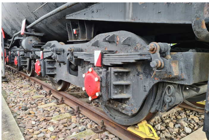
Rysunek 2.12: Wózki skrętne wyposażone w po dwie osie każdy
