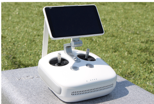
Rysunek 8.8: Nadajnik (aparatura) RC DJI Phantom
