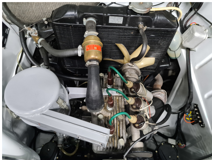
Rysunek 6.6: 3-cylindrowy silnik dwusuwowy z chłodzeniem cieczą (FSO Syrena Laminat)
