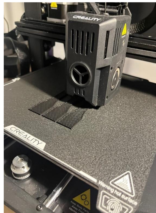
Rys 3. Widok z okna programu do opracowania technologii druku FDM oraz widok z procesu wydruku próbek do prób rozciągania.
