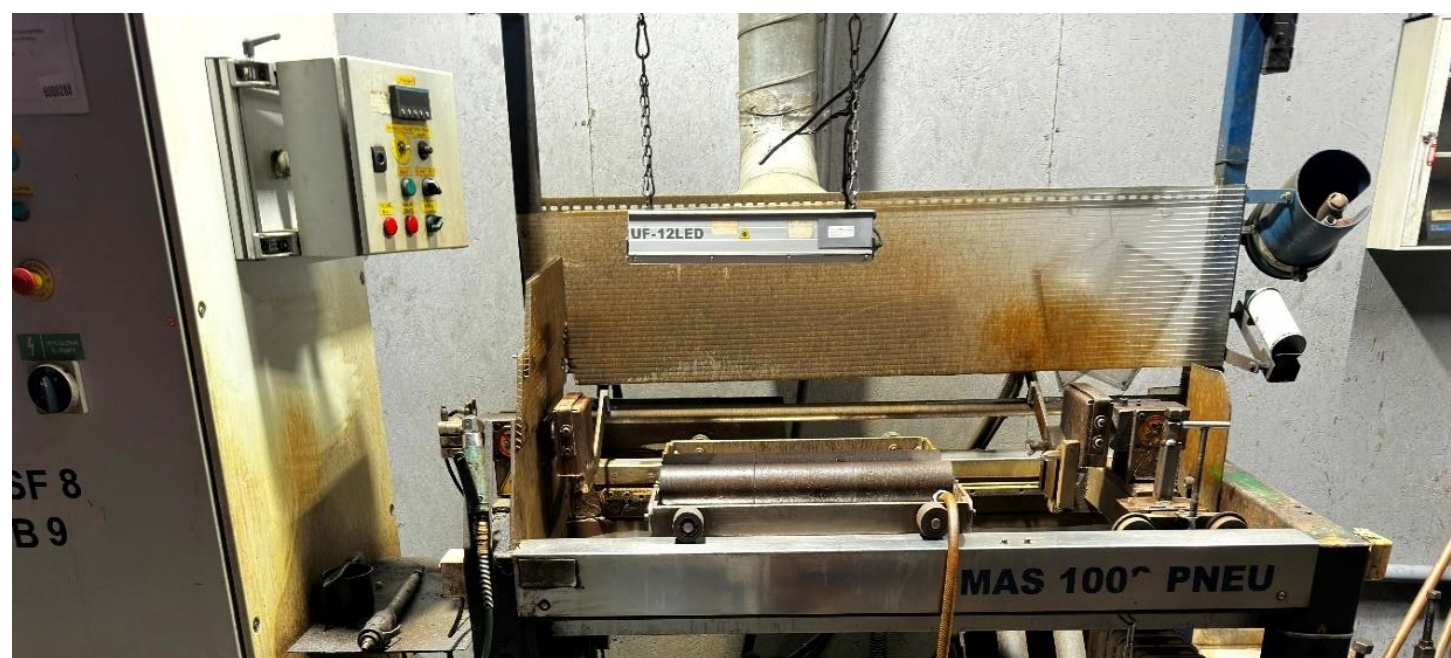
Rys. 2. Rzeczywiste stanowisko do badań magnetyczno-proszkowych
