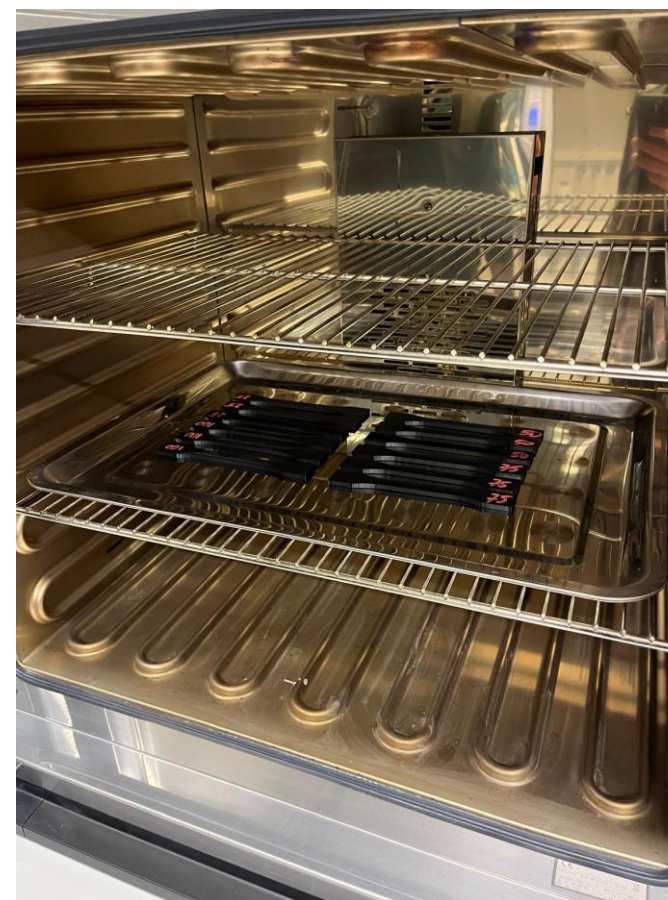
Rys 4. Widok: wypełnienia próbek, próbki w maszynie wytrzymałościowej po próbie rozciągania, sposób ułożenia próbek w trakcie wygrzewania w piecu.
