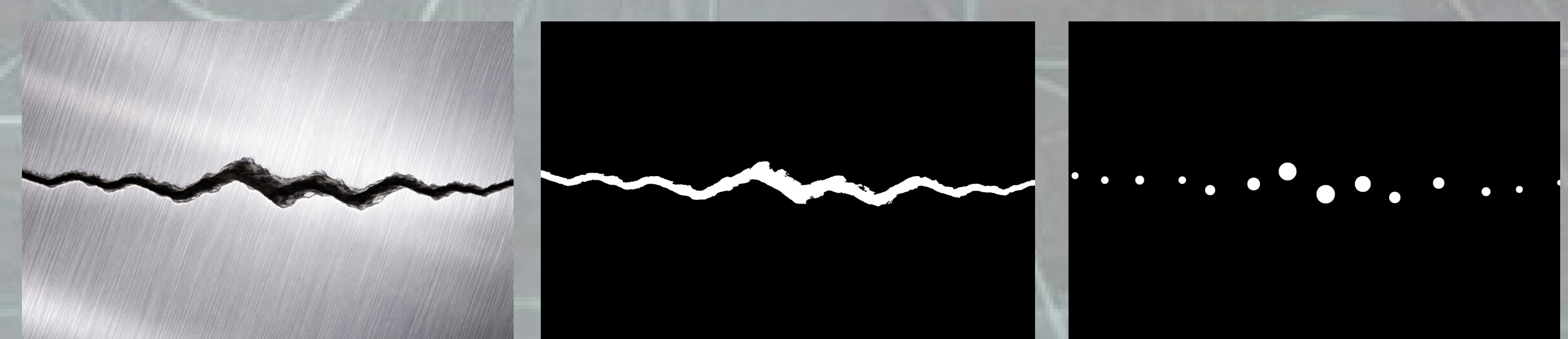
Rys. 5. Przebieg pracy związany z ekstrakcją uszkodzeń i określeniem punktów trajektorii naprawy oraz szerokości ścieżki. a) oryginalny obraz defektu, b) wyodrębniona maska defektu, c) przekształcenie maski z podzbiór kół, których definiują punkty trajektorii narzędzia, a średnice określają minimalną szerokość ścieżki napawania, d) zbiór kół nałożony na oryginalny obraz.
