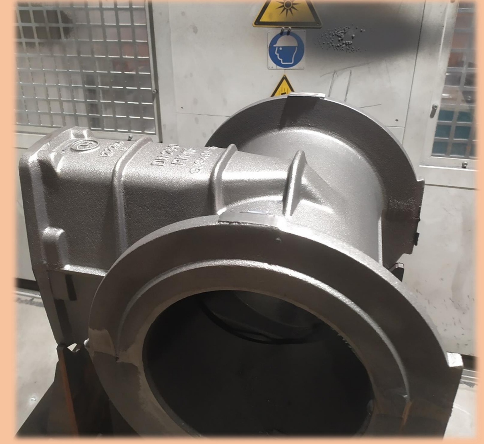
Rys. 3. Stanowisko do szlifowania robotem, surowy odlew bez wad
