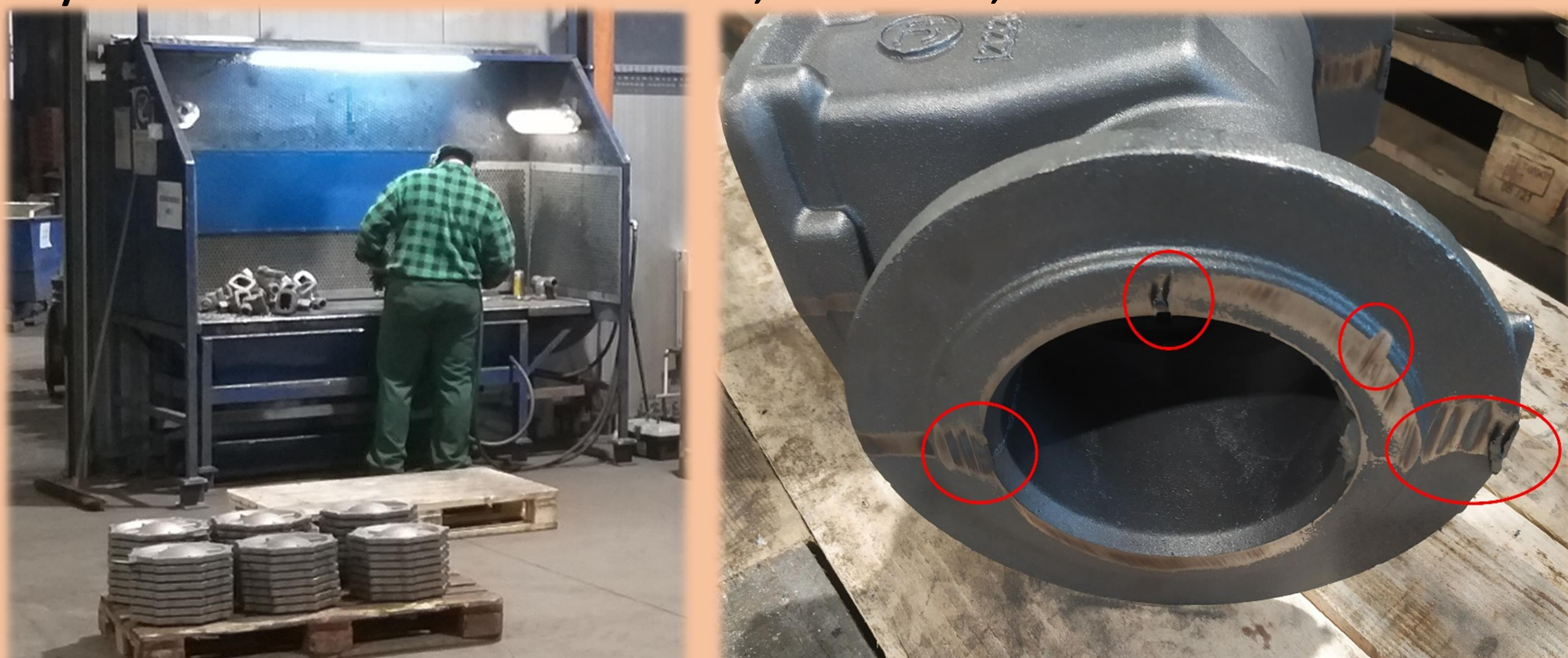
Rys. 2. Stanowisko do szlifowania ręcznego i surowy odlew, widoczne wady
