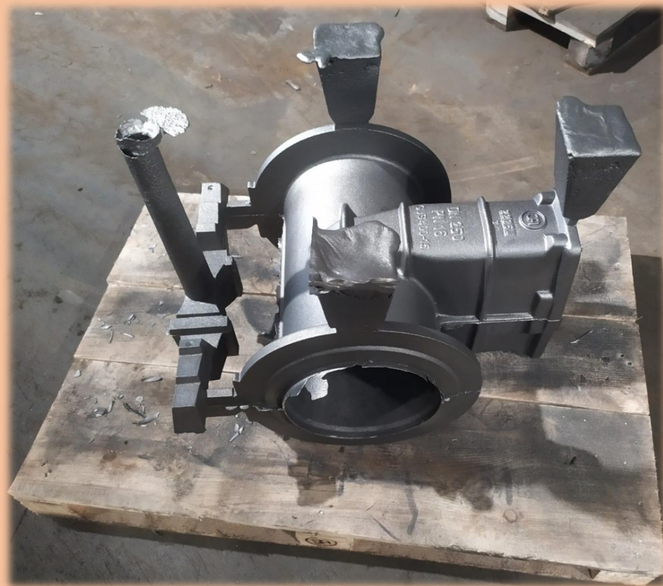
Rys. 1. Surowy odlew z układem wlewowym
